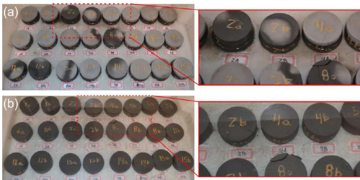
Figura 4.22 – (a) aspecto das amostras passadas as primeiras 4 horas de submersão, sendo evidenciado no detalhe fragmentação e fissuração de alguns corpos de prova; (b) aspecto final dos corpos de prova, passadas as 48 horas
