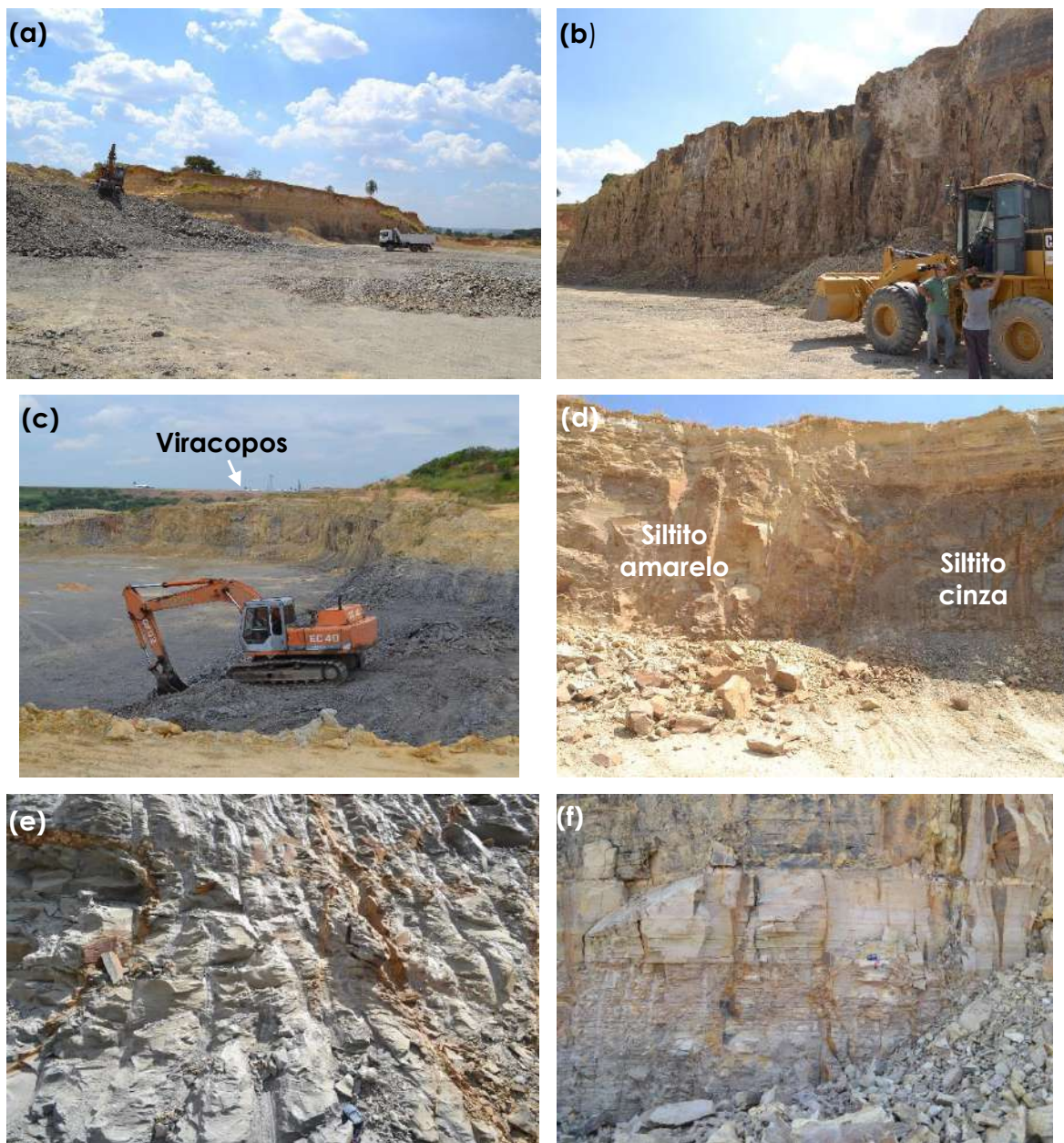
Figura 3.3 – Fotos da Pedreira Mingone, nas proximidades do aeroporto de Viracopos e às margens da ferrovia da ALL. Em (a), (b) e (c) aspectos gerais das frentes de lavra; (d) afloramento de siltitos amarelados e acimentados; (e) estrutura maciça visualizada para os siltitos cinza; (f) siltito amarronado ou chocolate, aspectos de sua laminação e do grau de intemperismo (empastilhamento)
