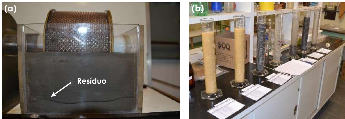
Figura 3.15 – (a) resíduo do ensaio de desgaste aquoso; (b) colunas de sedimentação
