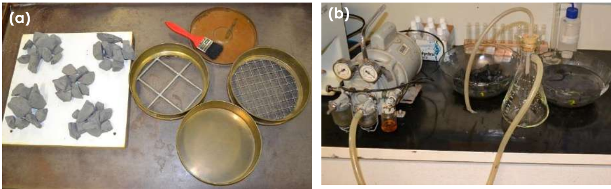
Figura 3.21 – (a) preparação de 50 fragmentos; (b) retirada da água deionizada dos recipientes por meio de bomba de sucção
