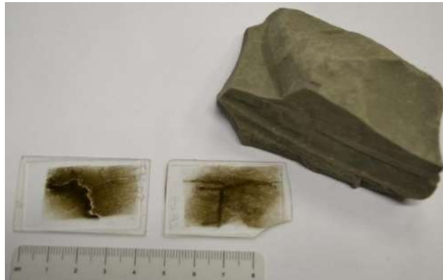
Figura 3.11 – Lâminas petrográficas a partir de amostra representativa do maciço rochoso dos siltitos do Grupo Itararé
