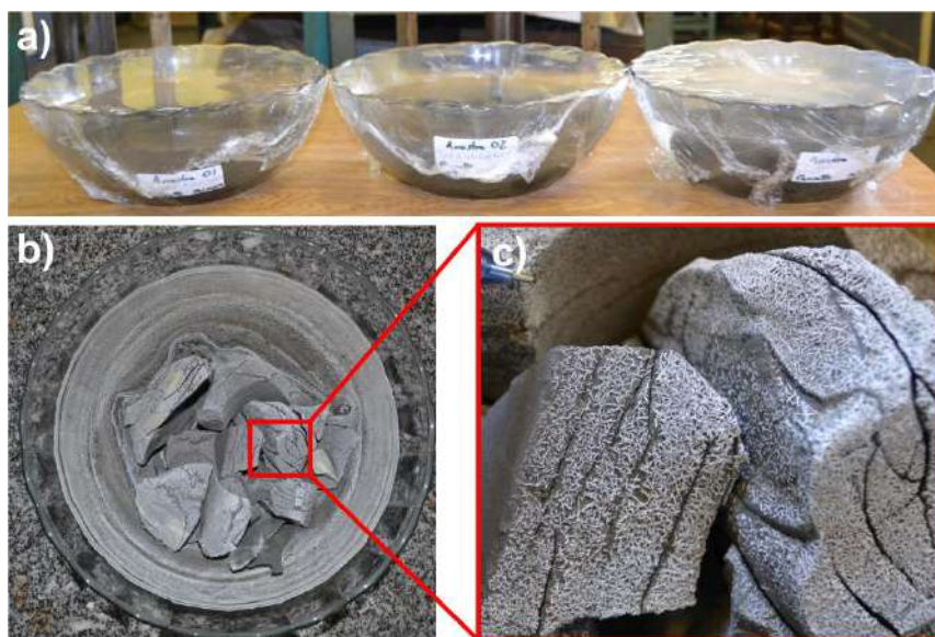
Figura 3.22 – (a) imersão das amostras em água deionizada; (b) aspecto das amostras na primeira secagem a 110°C; (c) detalhe de (b), mostrando a cristalização de sais(?), amostras com forte cheiro de sulfeto
